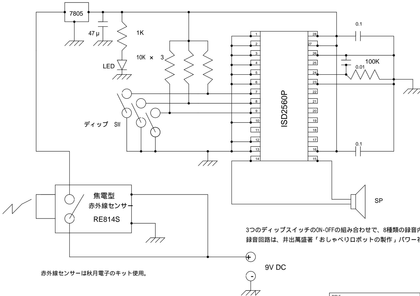
3つのディップスイッチのON-OFFの組み合わせで、8種類の録音内容を再生できます
