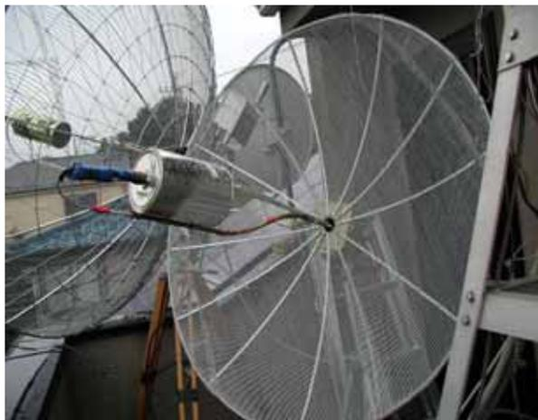
写真 6.ホーンを完成したパラボラに取り付け
