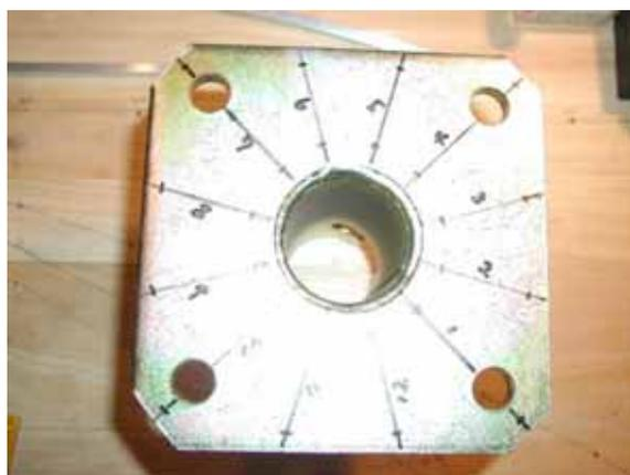
写真 3.ハブを 12 等分し 2 ヶ所ずつ止め穴を開ける
