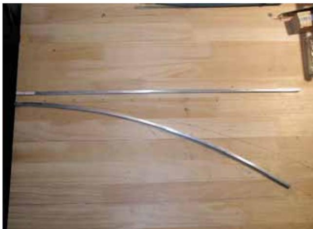
写真 2. アルミ角材を曲線に沿って曲げる
